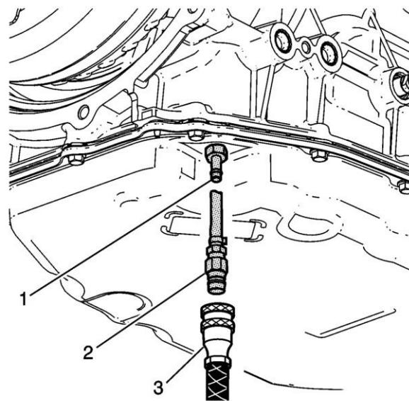
Instale el adaptador del cárter de relleno de fluido DT-51190 (1) y, si es necesario, un adaptador de los adaptadores de lavado del enfriador DT 45096-30 (2).
