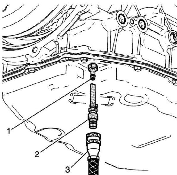
Poser l'adaptateur de carter de remplissage de liquide DT-51190 (1) et, si nécessaire un des adaptateurs de rinçage de refroidisseur DT 45096-30 (2).
