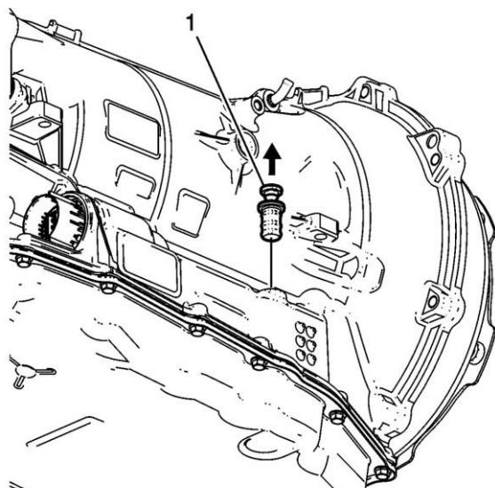
**Remarque :** il peut être nécessaire d'utiliser une pince à long bec effilé à 90 degrés pour lever le plongeur et déposer l'ensemble de bouchon.
