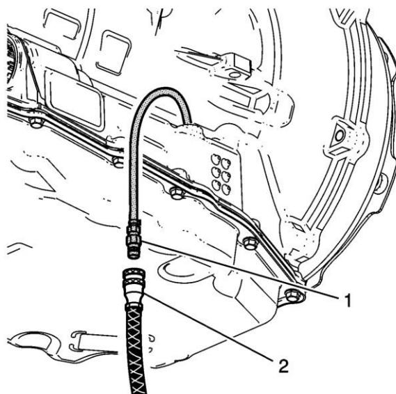
**Nota:** La herramienta de prueba de lavado y flujo DT-45096 se utiliza como un método conveniente para bombear el fluido al cárter inferior. También se puede usar una bomba manual adecuada en su lugar. Cuando use la herramienta de prueba de lavado y flujo DT-45096, monitoree el tablero de la pantalla para determinar la cantidad de fluido que se bombea del tanque de suministro de la herramienta a la transmisión.
