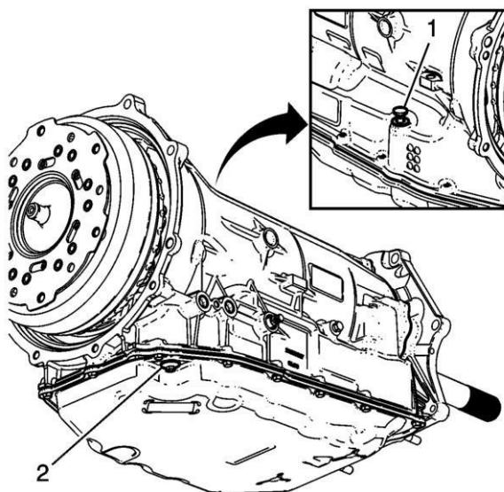
**Precaución:** Use fluido de transmisión Dexron® HP únicamente. La falla en usar el fluido adecuado puede resultar en daño interno a la transmisión.
