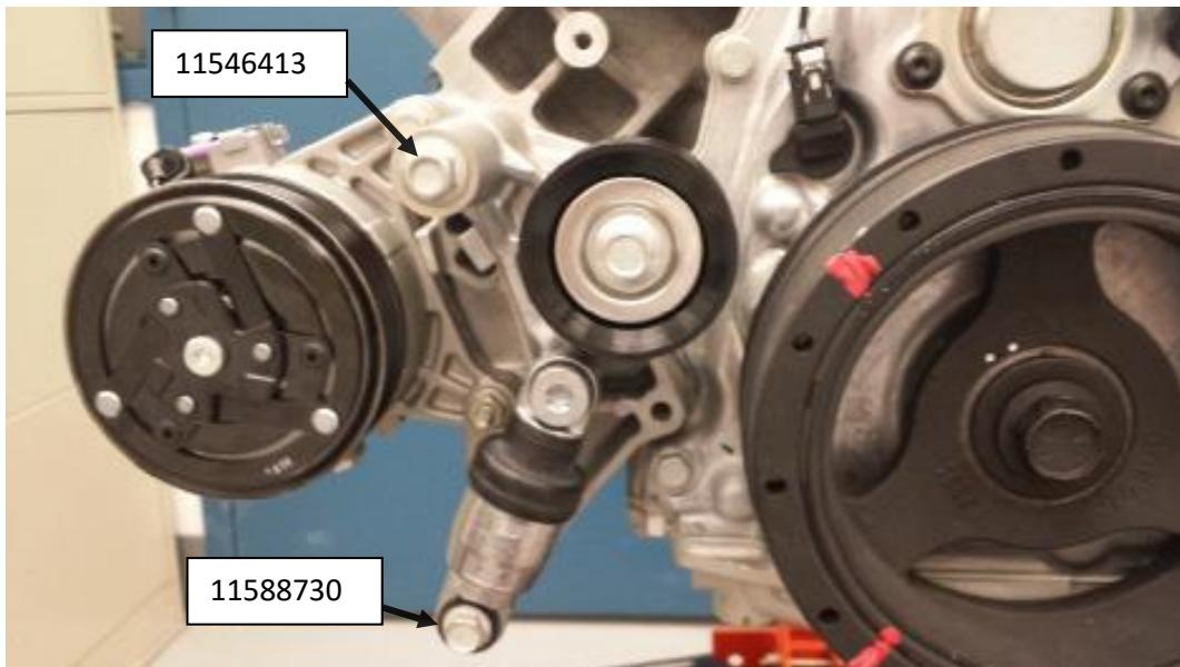
4. Poser l'alternateur 84331091 avec deux (2) boulons 11546413. Serrer l'écrou à 54 Nm (43 lb pi).
