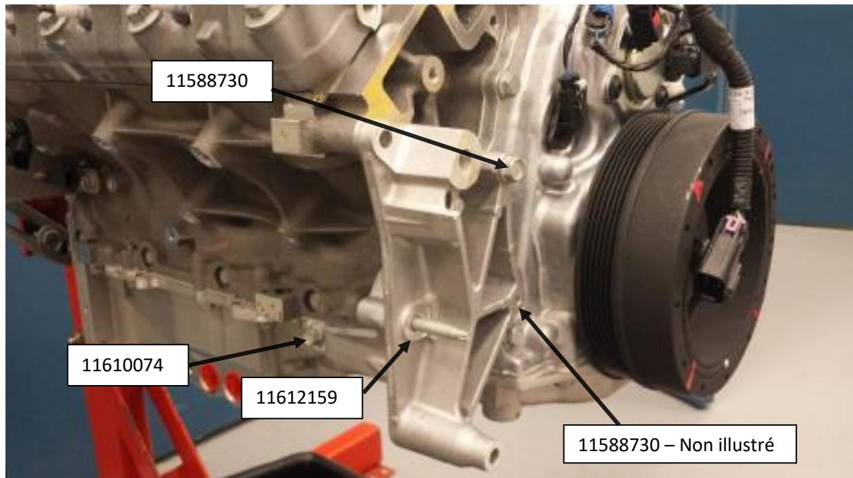
2. Poser le compresseur de climatiseur 84445509 avec 11588694. Serrer l'écrou à 22 Nm (16 lb pi). Poser l'écrou 11610074 sur le goujon. Serrer l'écrou à 22 Nm (16 lb pi).
